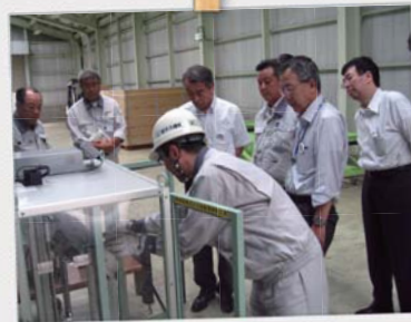
小口径配管の縦割工具の試験風景
