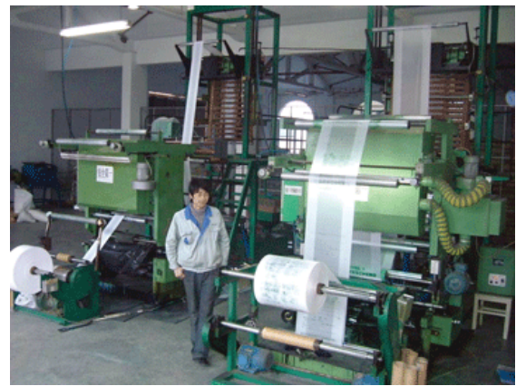
ごみ袋生産設備
