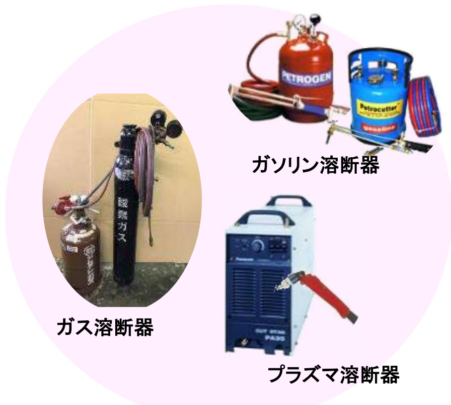
熱的切断工法
