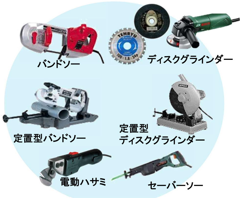
機械的切断工法
