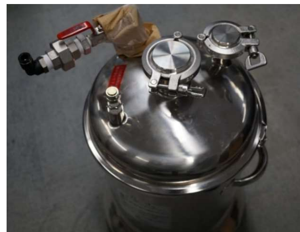
ふげんが所有する加減圧タンク (寸法:250×325mm 使用圧力:0.12kPa以上0.17MPa未満)
