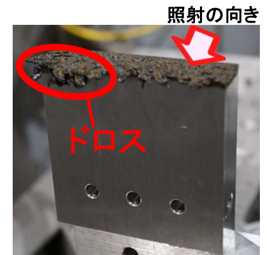
図2 レーザー照射後のドロスの様子
