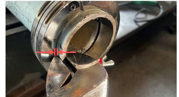
正規の取付け位置(蝶ねじが下)では、水平方向にリングと管に隙間ができ、保持力不足につながる
