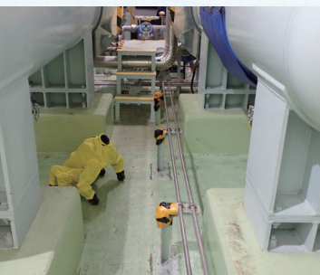
放射線3次元分布の取得と空間構造物イメージを得る試験 （「ふげん」原子炉補助建屋1F：敦賀）
